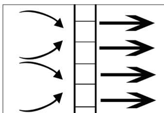
Redresseur de flux intégré : aucune section amont n'est nécessaire
