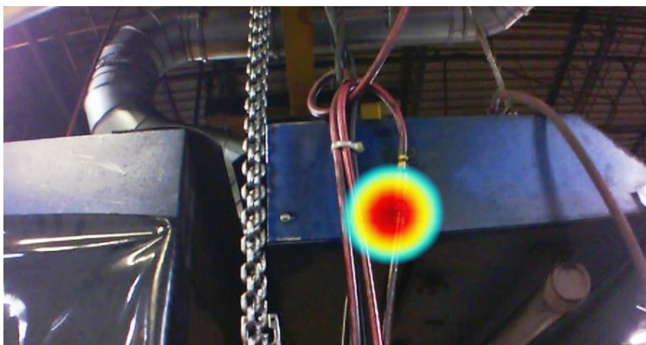
Image prise avec la caméra acoustique industrielle ii900 d'une fuite d'air dans un environnement industriel.
