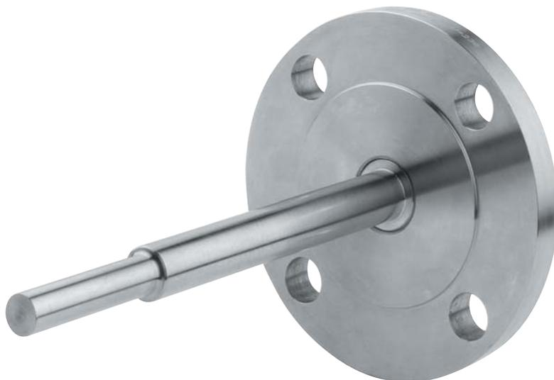
Les doigts de gant thermométriques sont conçus pour protéger l'instrument de mesure de la température de la corrosion, de la pression élevée ou de la vitesse du fluide de process et pour permettre le démontage de l'instrument sans que le système soit affecté. La série W92 est composée de doigts de gant de barre avec raccordement fileté. Ces instruments sont conçus pour travailler en conditions défavorables. La plongée d'immersion effilée permet une mesure précise de la température du process.
