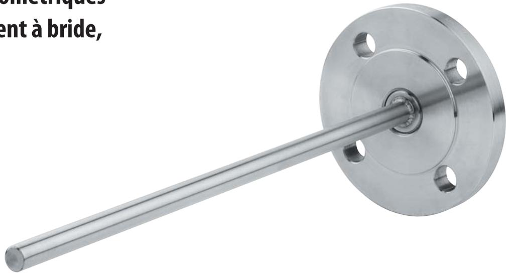
Les doigts de gant thermométriques sont conçus pour protéger l'instrument de mesure de la température de la corrosion, de la pression élevée ou de la vitesse du fluide de process et pour permettre le démontage de l'instrument sans que le système soit affecté. La série W82 est composée de doigts de gant forés avec raccordement à bride. Ces instruments sont conçus pour un travail de basse/moyenne intensité.
