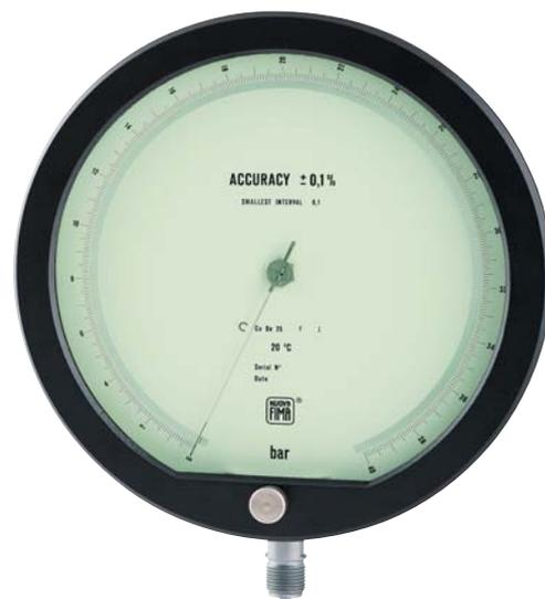
Ces appareils sont conçus pour servir de manomètres de contrôle ou de ré-étalonnage ou pour d'autres applications où la précision et la répétabilité sont de première importance. Les fluides de procès peuvent être liquides ou gazeux mais ne doivent pas présenter de viscosité élevée et ni cristalliser. Chaque instrument est accompagné par un rapport d'étalonnage Nuova Fima. Sur demande un document établi par un Laboratoire National (ACCREDIA) peut également être produit.
