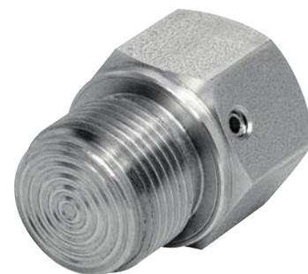
Utilisés pour isoler l'élément sensible des manomètres DN63, pressostats et transmetteurs électroniques de pression, des fluides de process corrosifs, visqueux, sédimenteux ou d'une température élevée. La membrane soudée et testée garantit la séparation du fluide de transmission de celui du process. La construction de ces appareils en permet l'utilisation chaque fois que les dimensions réduites et que la rapidité de nettoyage lors de manipulations fréquentes est importante.
