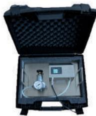
Mesure de la qualité de l'air comprimé
