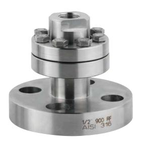
Utilisés pour isoler l'élément sensible des manomètres, pressostats et transmetteurs électroniques de pression, des fluides de process corrosifs, visqueux, sédimenteux ou d'une température élevée. Une membrane élastique serrée mécaniquement et testée, garantit la séparation du fluide de transmission de celui du process. L'étancheité métallique de la membrane garantit l'utilisation du séparateur sur de hautes températures en éliminant le problème des joints.
