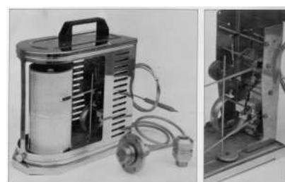
Cet instrument permet d'enregistrer à la fois la température et la pression de fluide.
