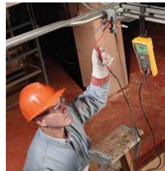
Le support magnétique (TPAK) du multimètre libère les deux mains et vous permet d'effectuer les mesures en toute sécurité.
