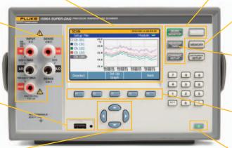
Touches de fonction principales rétro-éclairées : indication en permanence du mode d'opération et de l'état d'enregistrement.
