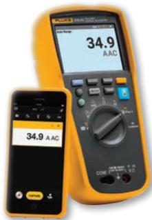
Grâce à la technologie intégrée Fluke Connect, transmettez les résultats sans fil vers un smartphone et signalez la fin d'un travail sans perte de temps.
