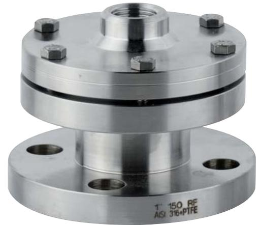
Utilisés pour isoler l'élément sensible des manomètres, pressostats et transmetteurs électroniques de pression, des fluides de process corrosifs, visqueux, sédimenteux ou d'une température élevée. Une membrane élastique serrée mécaniquement et testée, garantit la séparation du fluide de transmission de celui du process.
